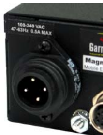
Fig 3.4c AC power input
